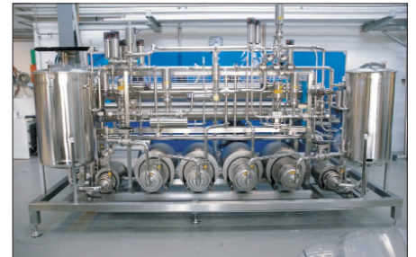
Система нанофильтрации в гигиеническом исполнении для концентрирования творожной сыворотки
